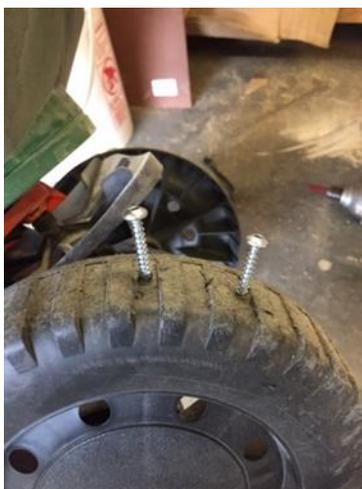
Voici une autre option simple et peu coûteuse. Cet épandeur peut contenir plus de 25 kg de produit. Les roues de l'appareil doivent tourner pour distribuer le produit, mais elles ne fonctionnent pas très bien sur la neige. Des vis peuvent être insérées dans les roues de plastique pour améliorer grandement la traction. Pour un parcours complet ou plusieurs sections, penser à avoir différents dépôts de produit pour améliorer l'efficacité du remplissage.
