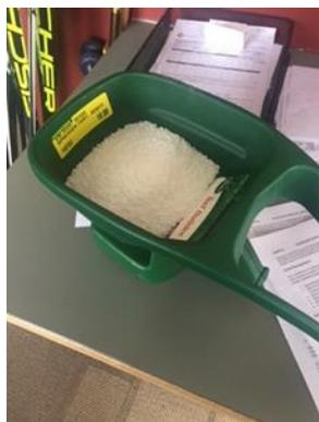
C'est un épandeur manuel très simple avec six réglages en fonction de la granulométrie. Il se vide très rapidement, il est donc utile d'avoir une personne supplémentaire avec un traîneau à neige pour transporter le produit afin que l'épandeur puisse être rempli rapidement.
